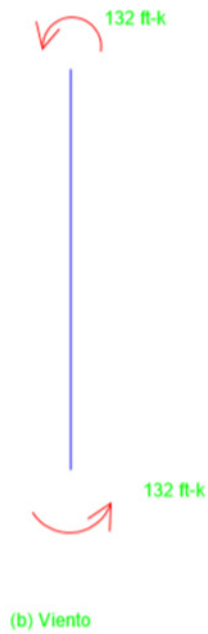
Ilustración 46. Momentos por viento obtenidos de un análisis de primer orden.
