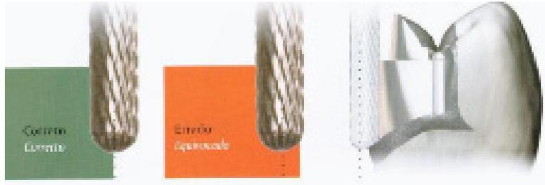
**Figura 7.12.** Esquema de correcta colocación de la profundidad de fresa para el desgaste.
