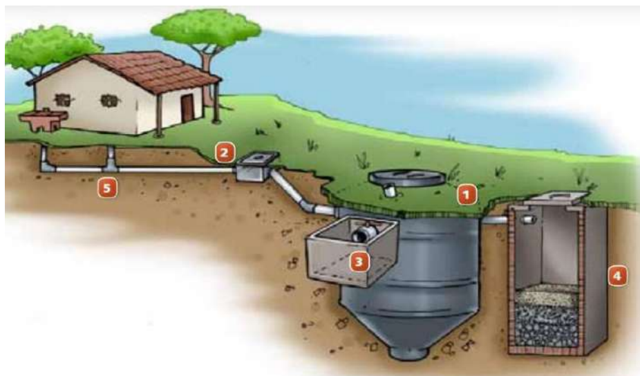
Figura 5. Componentes del sistema de tratamiento con biodigestor
