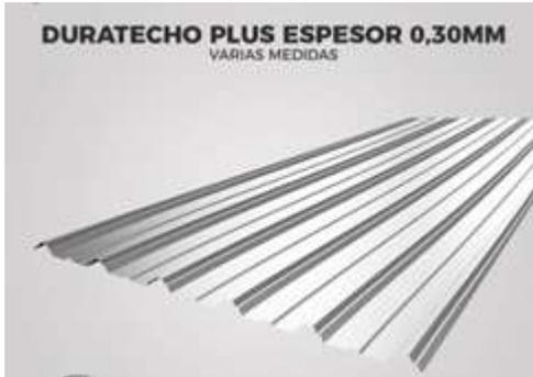
La parte superior de la armadura estará cubierta con placas de aleación de aluminio y zinc denominadas "DURATECHO" en cuyo caso se optará por "DURATECHO PLUS" ya que la coraza tiene un espesor de 0,30 mm, con 6 metros de largo y 1.10 metros de ancho, otorgando 6.6 m<sup>2</sup> de material efectivo para la conducción del calor, no se oxida y refleja los rayos del sol manteniendo el ambiente fresco.
