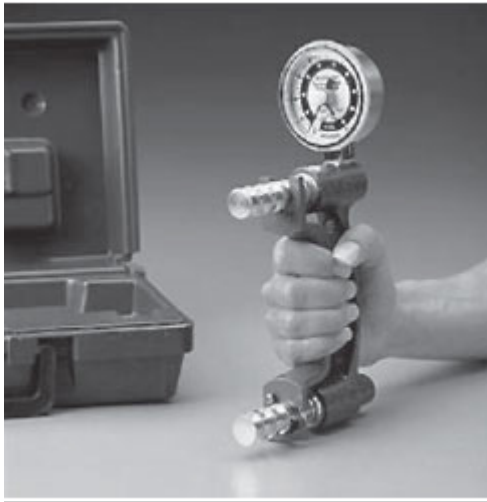
Figura 12. Dinamómetro de Jamar
