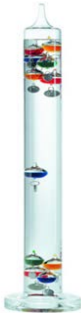
Figura 2 Termómetro de agua de Galileo
